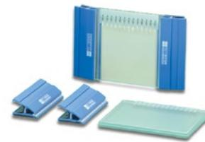
ガラスプレートの上にシールガasketを置きクリップで固定します。
