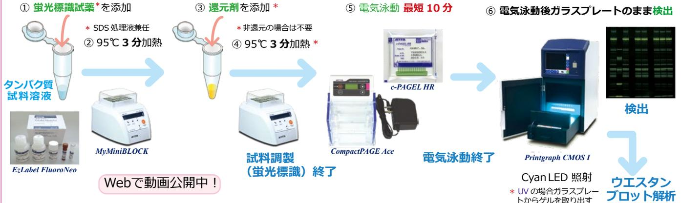
通常の SDS-PAGE 用サンプル処理とほぼ同じ操作、試料処理溶液を「**EzLabel FluoroNeo**」に換えるだけで蛍光標識が可能です。泳動後は染脱色なしにガラスプレートごと蛍光検出できます。「コンパクト PAGE Ace (Twin)」 「c-PAGEL HR」を利用すれば 20 分以内で検出まで実施。しかも高感度でさらにプロットも OK
