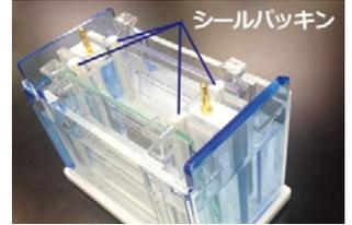
※高速泳動は、およそ電流200mA、電圧300V程度の出力が可能な電源装置と接続してご使用ください。
