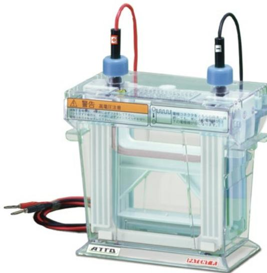
※高速泳動は、およそ電流200mA、電圧300V程度の出力が可能な電源装置と接続して
