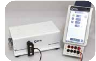
④ リード線をセットして、電源装置に接続しブロッティングを開始します
