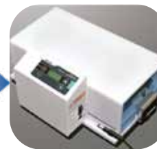
④ 電源部をセットし、ACアダプターを接続します。
