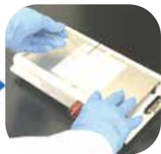
② 専用のローラーで泡抜きを行います
