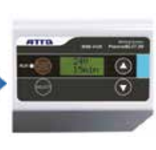
⑤ モードを選択し、RUNボタンを押してブロッキングを開始します
