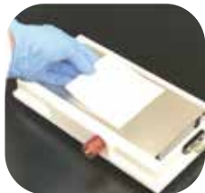
① 電源部、上部電極を取り外し、下部電極上でろ紙・メンブレン・ゲルを重ねます
