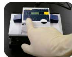
④ モードを選択し、RUN ボタンを押してブロッキングを開始します
