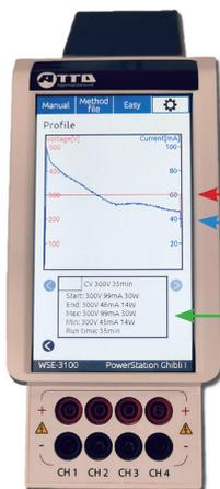
横軸が時間 (35 分) となり、電圧の変化、電流の変化がグラフ表示されます。また、電気泳動の際の開始時、終了時、最大時、最小時の電圧値、電流値、電力値、および 泳動時間の記録を確認することが可能です。
