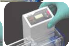
安全カバーをおろして 電源部をセッティング ACコードを接続
