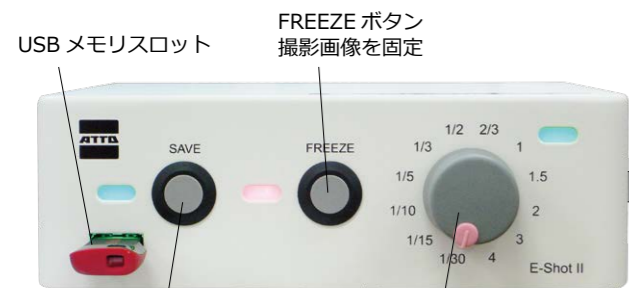
SAVE ボタン 撮影画像を USB メモリまたは PC へ保存 FREEZE ボタン 撮影画像を固定 Exposure Time シャッタースピード調整 1/30 秒 ~ 4 秒
