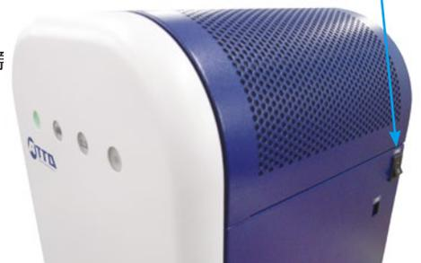
電源投入後、冷却インジケータは「緑⇄黄」に点滅し冷却温度下降中であることを示します。およそ3~5分ほどで-30℃まで温度が下がります。
