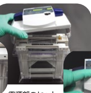
電源部のセット AC接続
